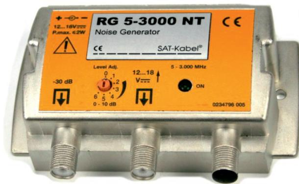
Der handliche Rauschgenerator RG 3000 ist ein Messmittel um frequenzabhängige Dämpfungen in Kabel- und Sat-Anlagen zu überprüfen. Das Gerät generiert ein breitbandiges Rauschsignal von 5 bis 3000 MHz. Somit kann mit einem Pegelmessgerät auf der Gegenseite gemessen werden, ohne dass ein Antennensignal erforderlich ist.
